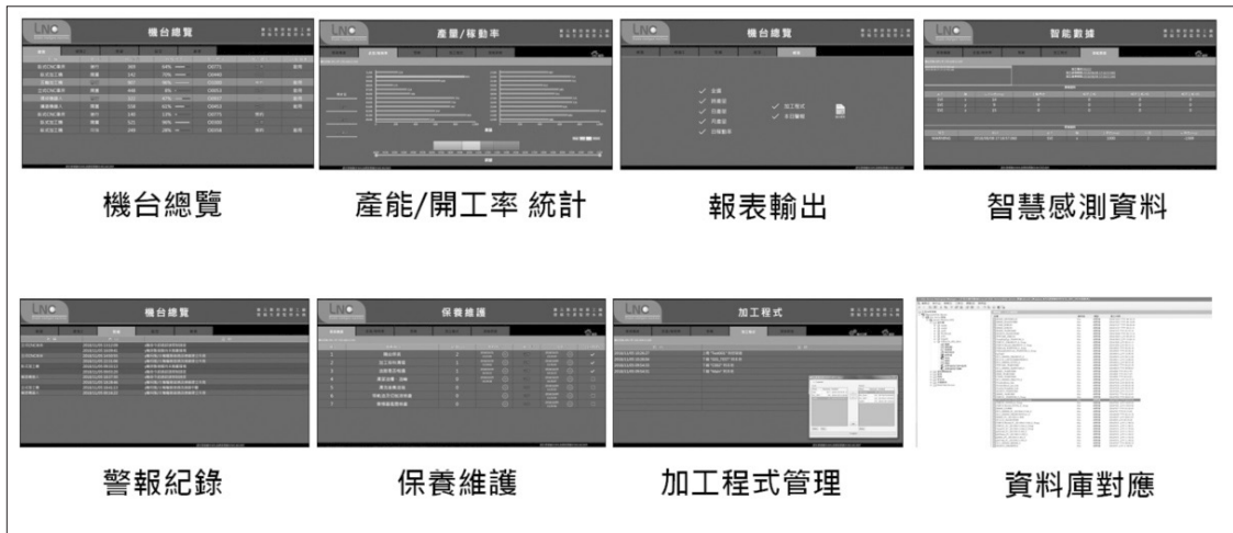
圖 6 寶元數控 LNC SCADA 的八大功能頁面
