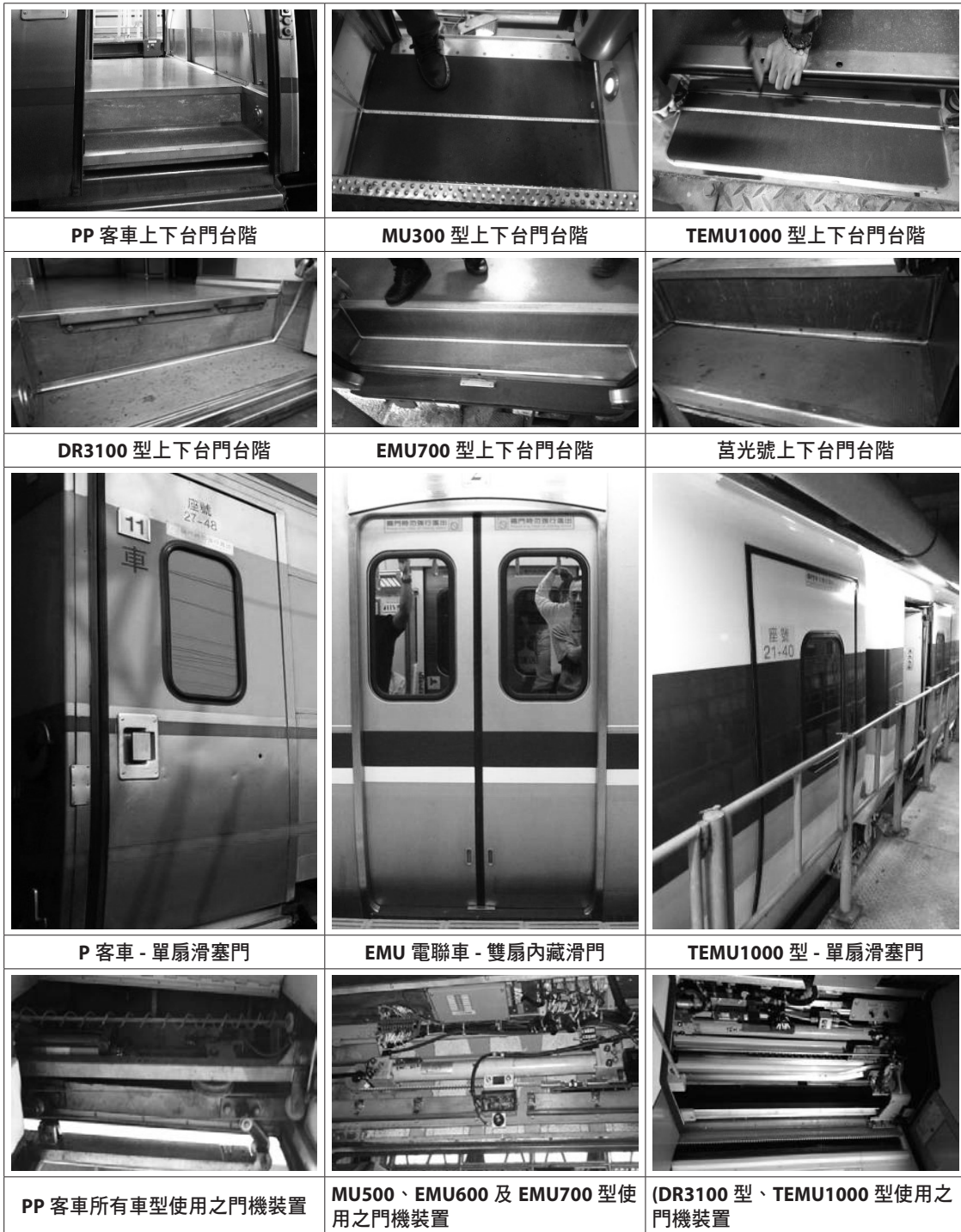
圖 1 各型列車既有之上下台門台階及門機裝置
