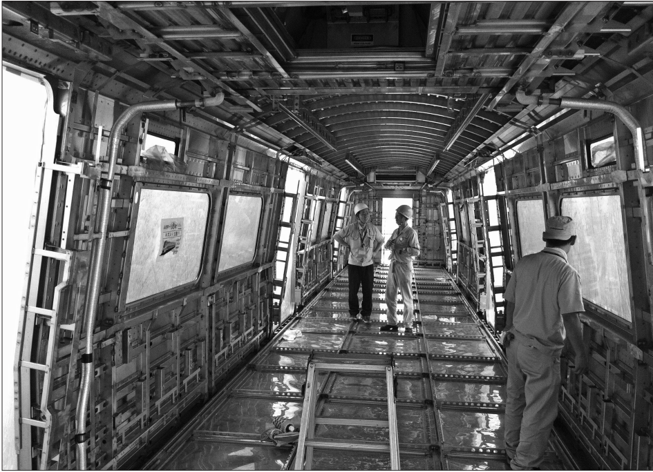
圖 4 車體水密測試
