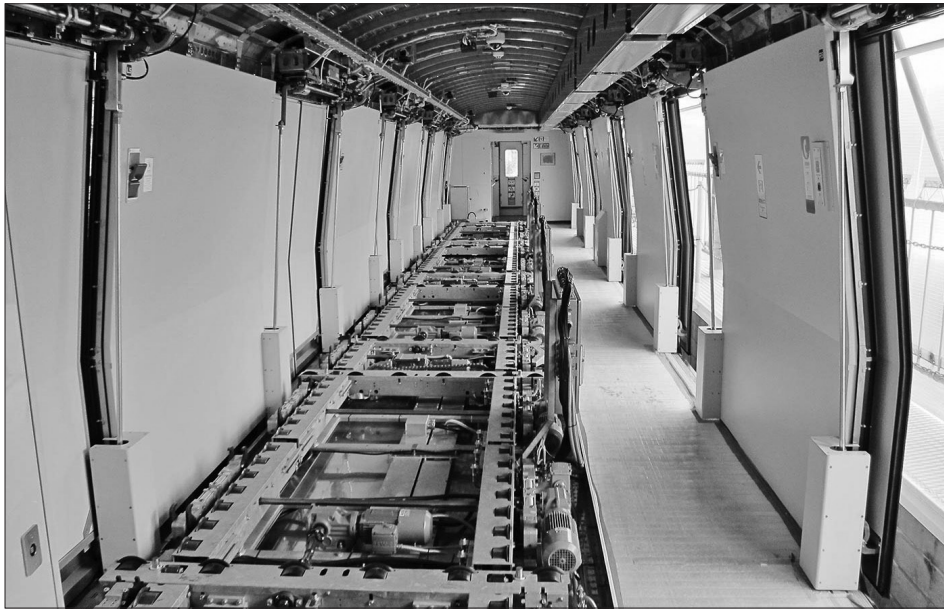
圖 3 車載行李處理系統 (OTBHE) (2)
