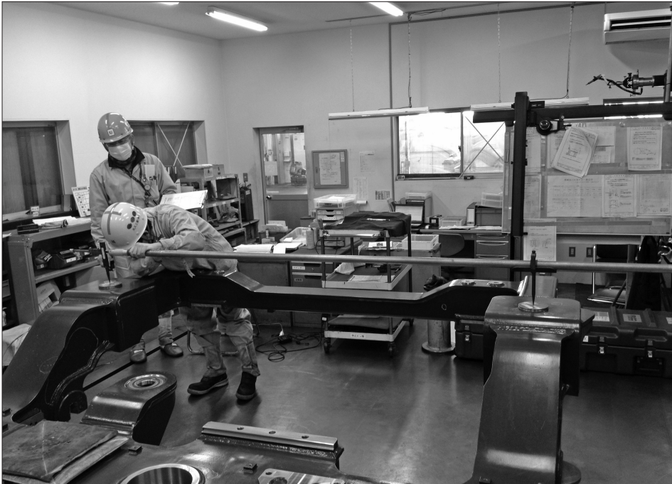
圖 5 轉向架框尺寸量測作業
