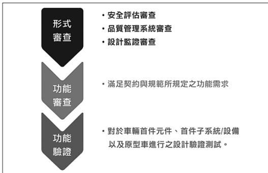
圖 11 車輛設計審查、監造與驗證作業概念示意
